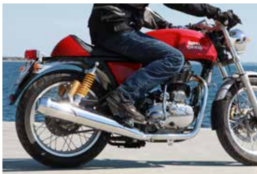
Benstillingen på Continental GT er god, men sædet er hårdt og egner sig ikke til længere ture. Designeren har dog monteret afstandsholder bag ved hælen – en fin detalje ligesom gasbagdæmperne.
